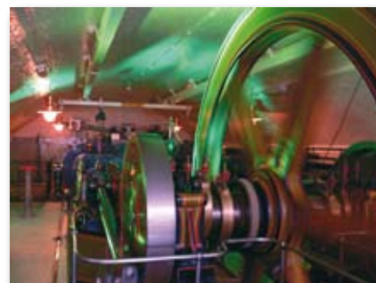
Mechanizm podnoszący Tower Bridge
