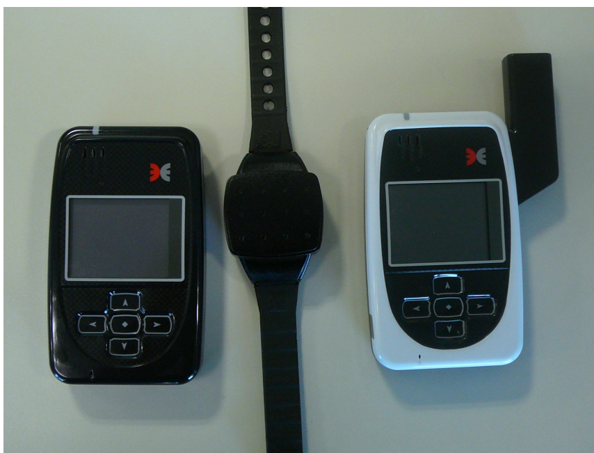
Zdjęcie 15. Urządzenia dla sprawcy oraz ofiary przemocy funkcjonujące w ramach systemu GPS.
