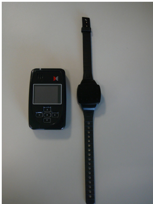
Zdjęcie 13. Urządzenia dla sprawcy przemocy: bransoleta oraz nadajnik.
